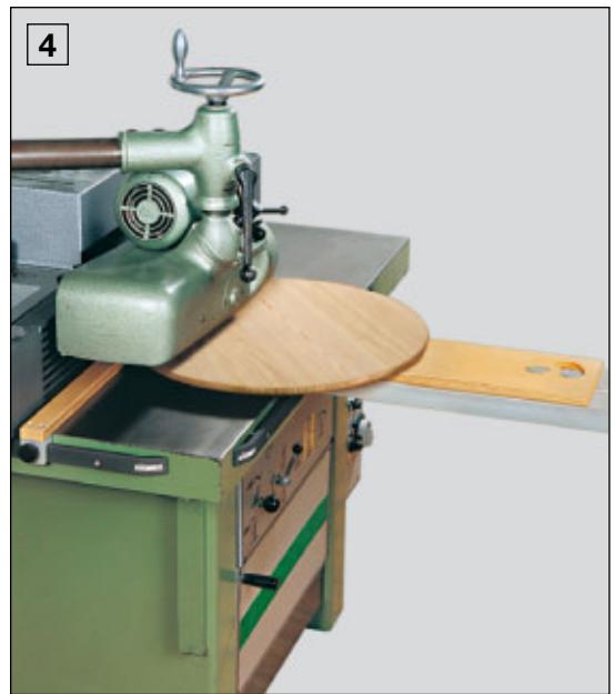
**1** Pièce à usiner fixée sur le touillon de la plaque de guidage en position d'attaque.
