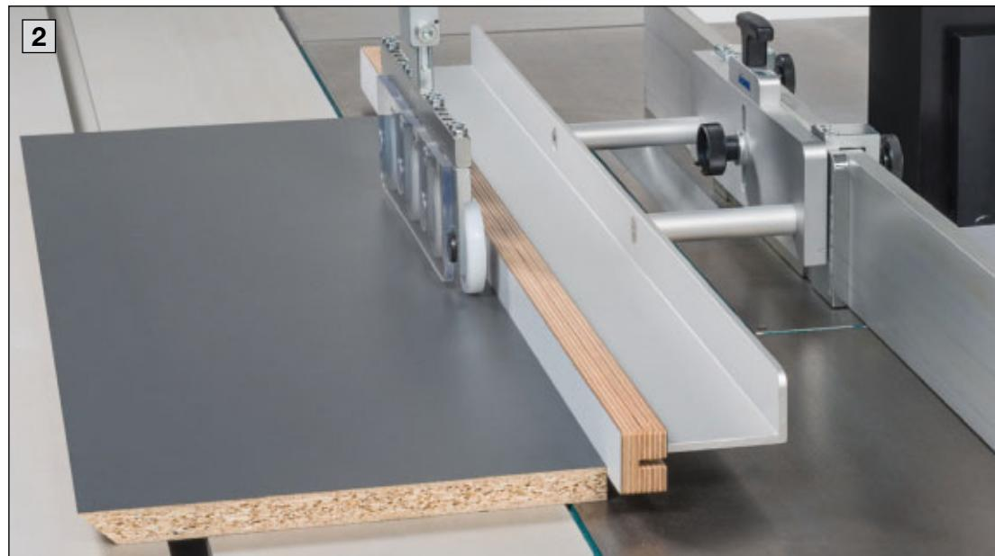
**1** Barre-Guide avec Galet de sécurité, lame de scie inclinée à l'angle voulu.
