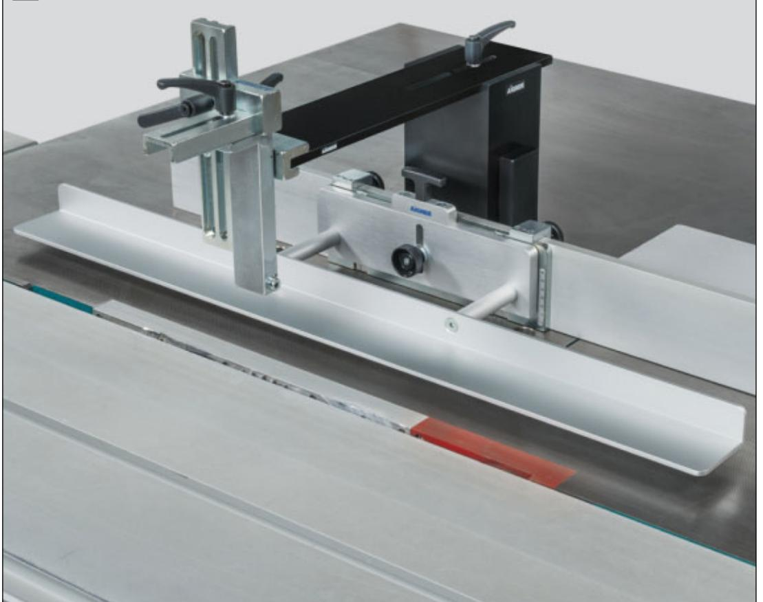
**1** Plaque-Support placée sur la Colonne de fixation côté court vers le Module-Presseur
